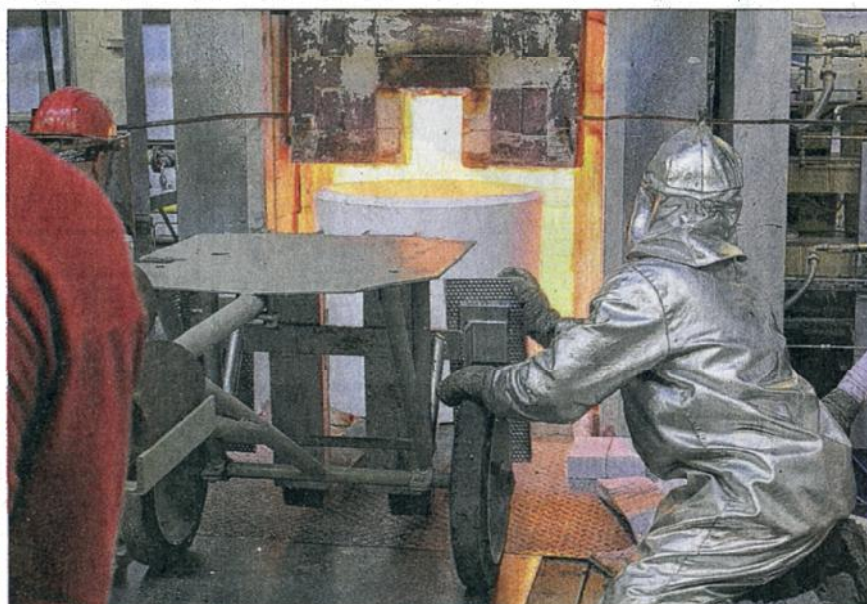
Vielleicht hat Hüttenmeister Holger Müller (Bild links) den heißesten Arbeitsplatz der Ortenau: Bevor in der Dorotheenhütte der Glas-Schmelztiegel (Bild Mitte) geborgen und durch einen neuen ersetzt werden kann (Bild rechts), muss der Ofen auf 1400 Grad Celsius vorgeheizt werden.
