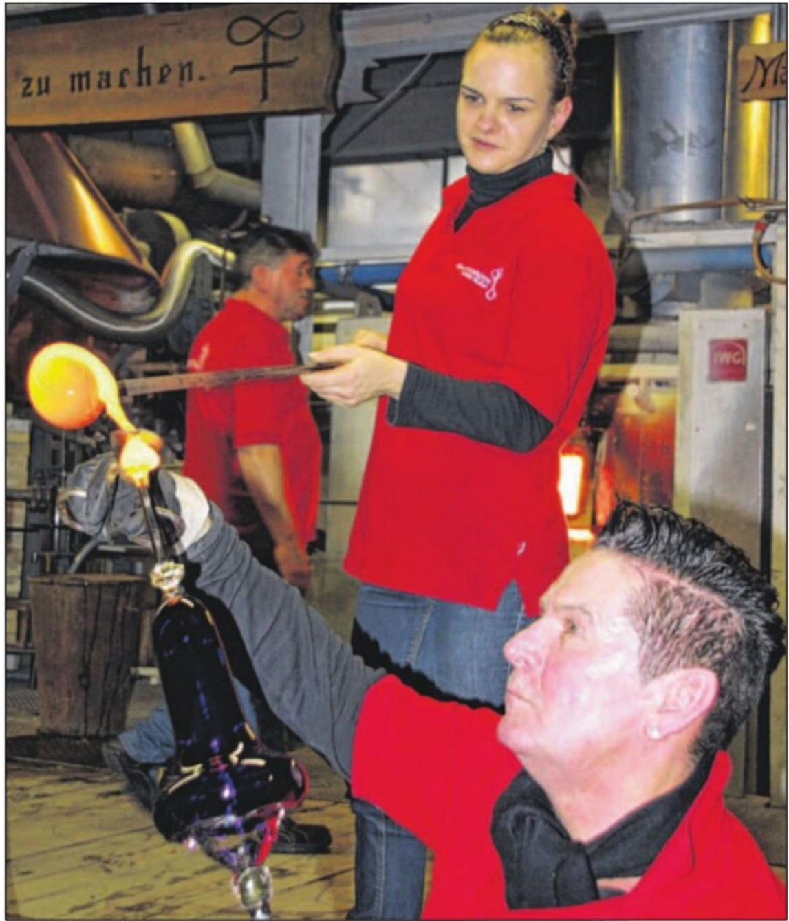
Heidi Anger reicht ihrem Kollegen geschmolzenes Glas aus dem Ofen für den Boden des fast fertigen Stücks. Die 25-jährige Glasmacherin ist von ihrem Beruf begeistert und schloss die Ausbildung in der Dorotheenhütte jetzt als Bundessiegerin ab.
